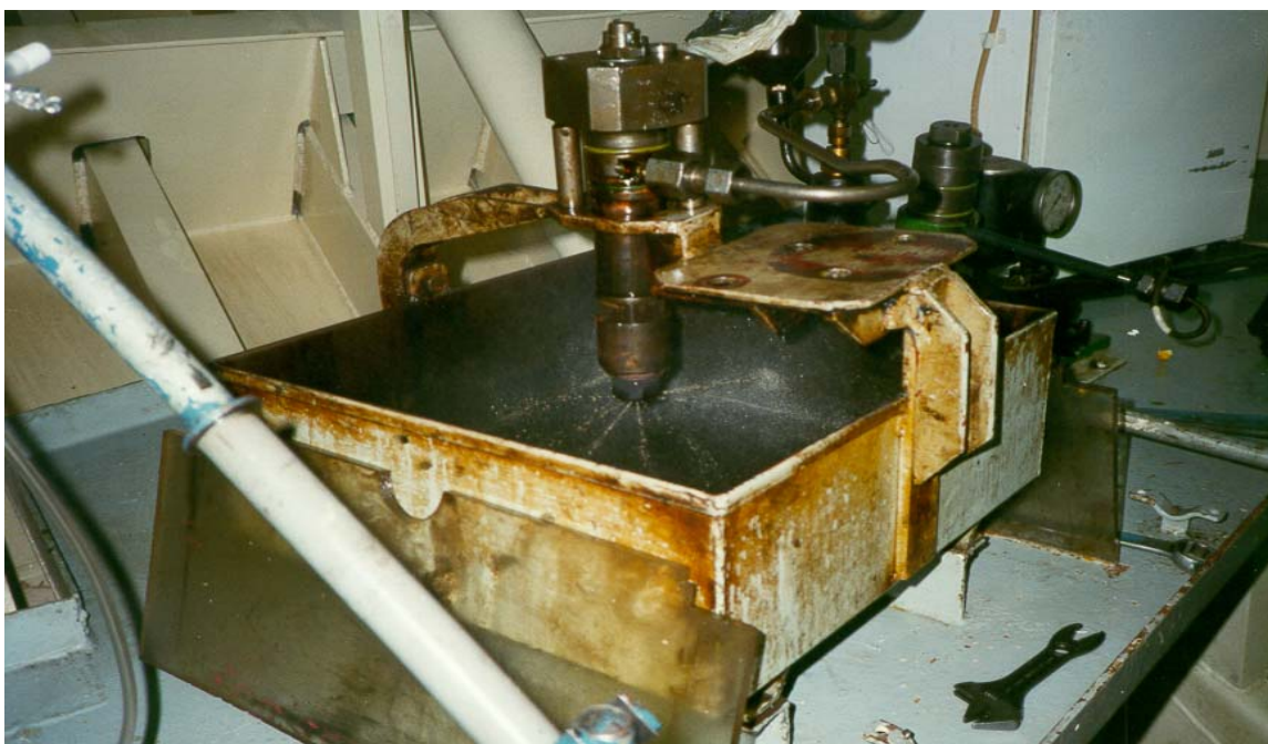
Figur 2. Bildning av oljedimma vid provtryckning av bränsleventil.
