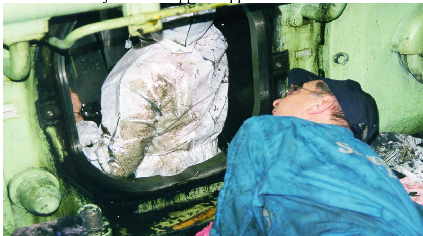
Figur 4. Reparator inuti vevhuset på huvudmaskin vid kolvhalning.
