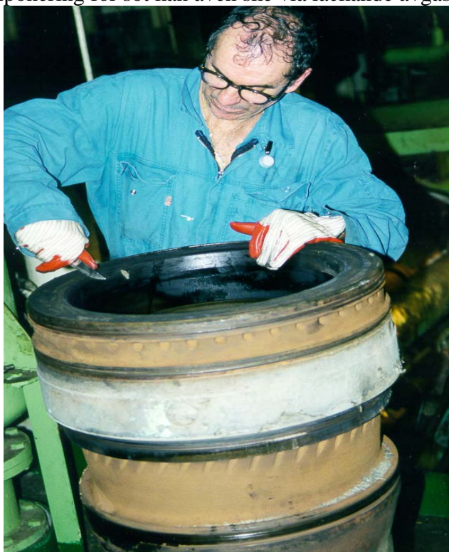
Figur 5. Överhalning av maskindel med sot.
